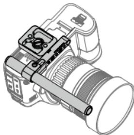
5. 安装相机固定板后，安装跟焦器电机至安装组件。
